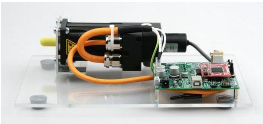
Figuur 1: Synchronische Motor met Permanente Magneet (PMSM) [3]
